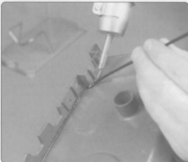
*При помощи маятниковой сварки возможен ремонт трещин в труднодоступных местах. При этом используется нормальная насадка, а сварочный пруток подается по прямым углом.*
