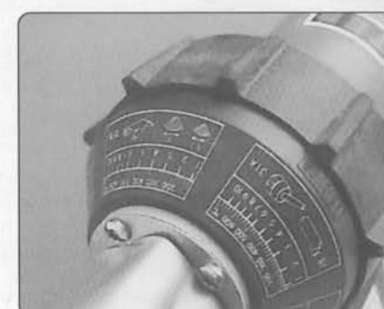
Нанесенная на корпусе аппарата температурная шкала позволяет точно выставить температуру в зависимости от используемой насадки.
