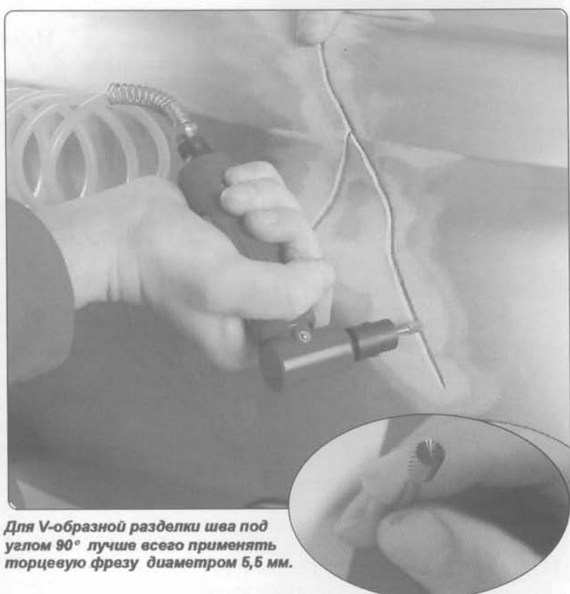
Для V-образной разделки шва под углом 90° лучше всего применять торцевую фрезу диаметром 5,5 мм.
