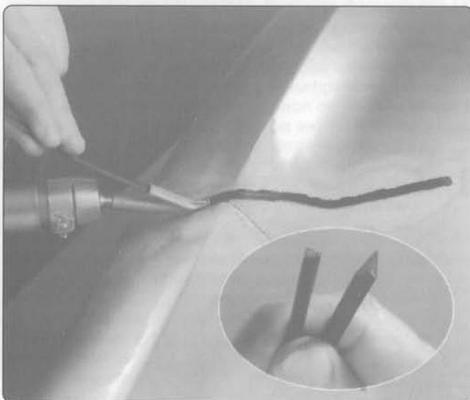
Перед сваркой необходимо острым ножом или кусачками срезать конец сварочной присадки под углом 45°. Таким образом обработанная присадка делает возможным постепенное заполнение V-образного сварочного канала, особенно если он начинается в середине кузовной части. После этого необходимо насадить на аппарат насадку быстрой сварки (номер по каталогу 27B) и установить правильную температуру сварки. Перед тем как начать работу аппарат необходимо разогреть до нужной температуры в течении 2-3 минут.
