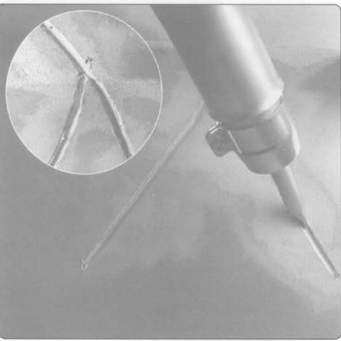
*Скрепляющая сварка кайловой насадкой позволяет совмещать соединяемые поверхности перед сваркой и фиксировать их.*
